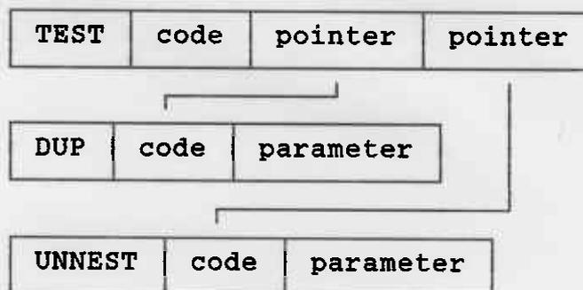
Das Wort : hat den Namen TEST erzeugt. UNNEST wurde durch das Wort ; erzeugt
