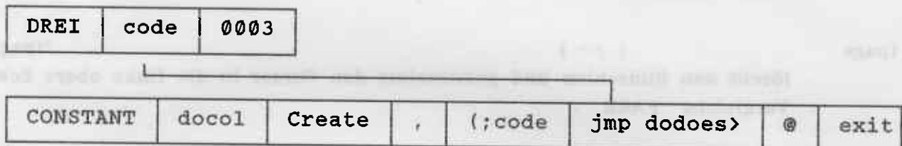
Das Wort **(;CODE** wurde durch **DOES>** erzeugt. Es setzt das Codefeld des durch **CREATE** erzeugten Wortes **DREI** und beendet dann die Ausführung von **CONSTANT**. Das Codefeld von **DREI** zeigt anschließend auf **jmp dodoes>**. Wird **DREI** später aufgerufen, so wird der zugeordnete Code ausgeführt. Das ist in diesem Fall **jmp dodoes>**.
