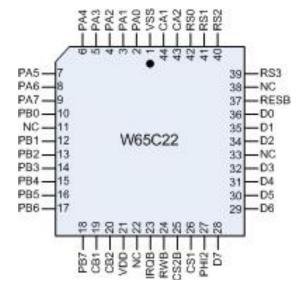
Figure 3-2 W65C22 44 Pin PLCC Pinout
