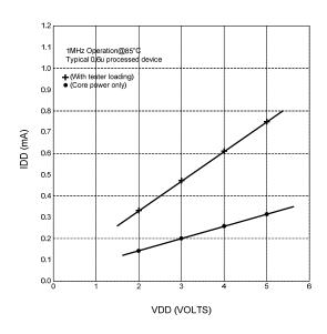
Figure 4-1a W65C22N IDD vs. VDD
