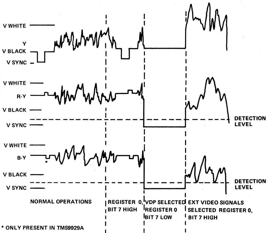
FIGURE 2-6 — TMS9928A/9929A SIGNAL WAVEFORMS FOR MULTIPLE VDP OPERATION
