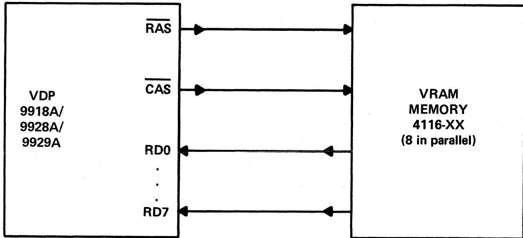
FIGURE B-1 – MEMORY CONFIGURATION SHOWING DELAY TIMES
