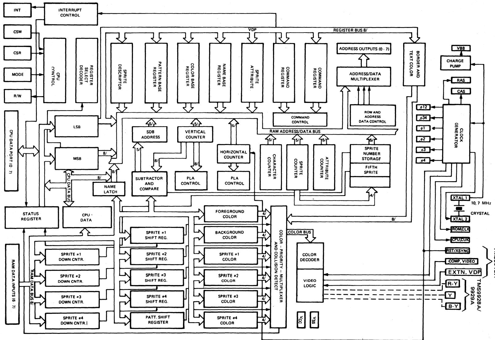
FIGURE 2-1 — VDP BLOCK DIAGRAM
