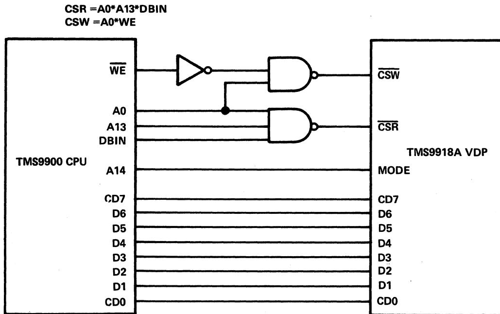
FIGURE 4-1 — MINIMUM SYSTEM INTERFACE TO TMS9900
